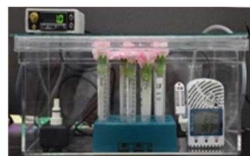
低酸素培養システム 窒素ガスを通気し、コントローラーで酸素濃度を調節する。
