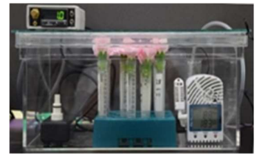
低酸素培養システム 窒素ガスを通気し、コントローラーで酸素濃度を調節する。
