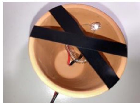
(7) ヒーター(ニクロム線と判定用 LED)
